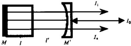
图1 半整体腔双谐振 OPO 理论模型( $l$  为晶体长度, $l'$  为晶体与腔镜  $M$  的距离, $I_0$ 、 $I_i$ 、 $I_s$  为抽运光,下转换闲散光和信号光)
